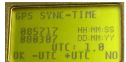
**¡ Atención!** Tras la recepción de una señal GPS valida, el TIMY3 verifica la suma de comprobación y mide la duración de la señal de sincronización. Si la señal de sincronización es errónea, el TIMY3 realiza un reset. Por lo tanto, es imposible generar un tiempo de sincronización no válido. Si el TIMY3 está alimentado también por energía externa, se reinicia automáticamente. En caso de funcionamiento con alimentación interna, la TIMY3 se apaga y tiene que ser reiniciado.
