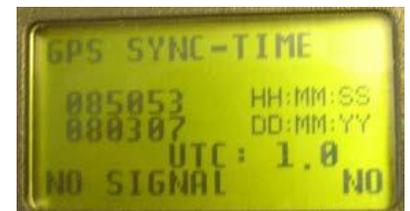
Cuando "OK-UTC + UTC NO" se muestra en la línea de fondo, el tiempo de su región puede ajustarse con las teclas <F1>y <F2> Tan pronto como se muestra la hora correcta, pulse <OK>
