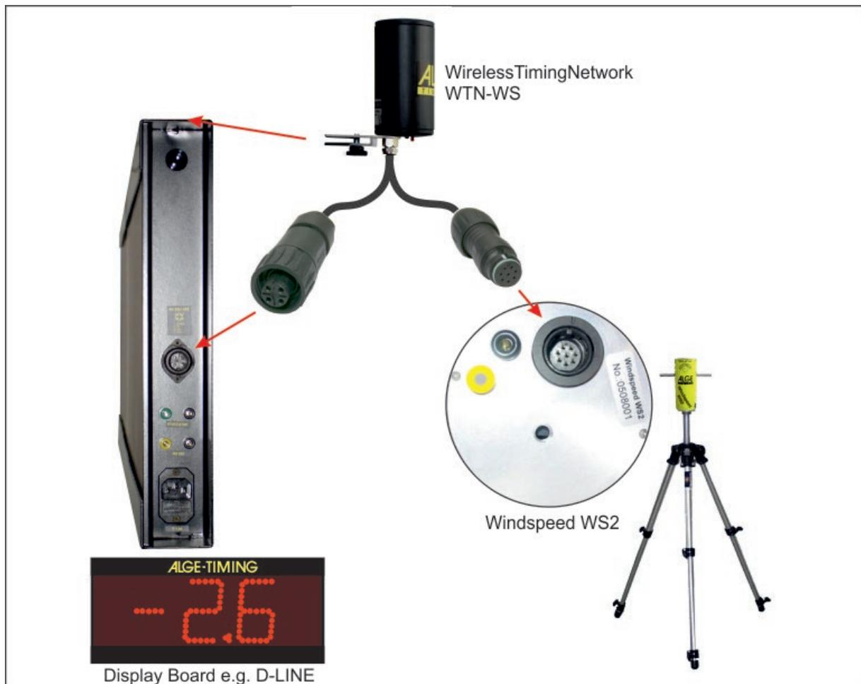
Анемометр WS2 связывается с Timy3 W по радио. Питание для WS2 и WTN-WS поступает от внешнего источника (например, устройства резервного питания BBG или аккумулятора 12 В).
