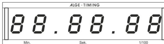
Die Zeit wird immer für die Dauer der „Display Schleppzeit 2“ angezeigt (Menü 5). Wird als „Display Schleppzeit 2“ Null eingestellt, wird jede Zeit angezeigt, bis sie von einem weiteren Impuls des gleichen Kanals überschrieben wird.
