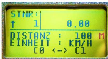
После пересечения стартовых створ на дисплее вместо 0.00 будет пунктирная линия. После пересечения второй пары створ, будет отображена скорость. Таймер автоматически подсчитает, при данных настройках дистанции и минимальной скорости, максимальное время прохождения дистанции.
