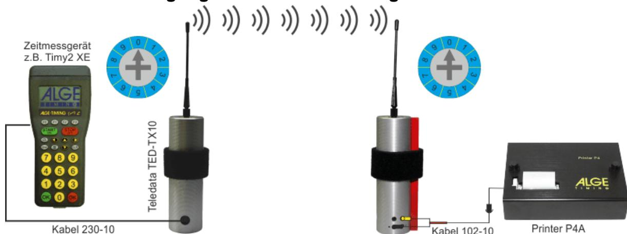
Wird der Ausgang „RS232“ vom Zeitmessgerät benutzt, muss beim TED-TX das Kabel 060-10 verwendet werden.
