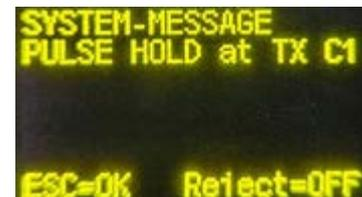
In diesem Beispiel ist der Zeitmesskanal C1 beim Sender dauernd ausgelöst. Standardmäßig ist diese Funktion für den Kanal C0 deaktiviert (Pulse hold = 0.0). Für C1 ist die voreingestellte Zeit 5 Sekunden.
