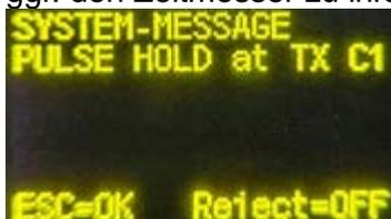
Mit der ESC-Taste wird die Meldung geschlossen. Mit der „OFF“-Taste wird die Meldung dauerhaft beim Empfänger deaktiviert.
