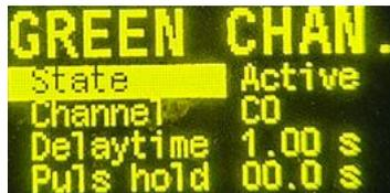
Mit den Pfeiltasten (,2' für aufwärts, ,8' für abwärts) können Sie die Einstellung anwählen. Mit ← können Sie diese Einstellung bearbeiten. Wählen Sie die Einstellung aus und bestätigen Sie diese mit ←. Durch Drücken der ESC Taste verlassen Sie die Einstellung ohne diese zu ändern.
