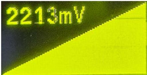
Je höher dieser Wert ist, desto besser ist der Empfang. Wenn keine Feldstärke am Empfänger angezeigt wird, dann ist dieser außerhalb der Reichweite. Ab etwa 1200mV ist ein stabiler Empfang möglich.
