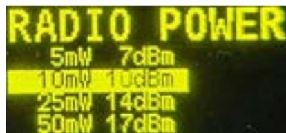
Das Gerät arbeitet im EU-weit harmonisierten ISM Band. In der EU dürfen Funkgeräte bis zu 10mW (SRD) lizenzfrei verwendet werden. Einige Länder erlauben bis zu 500mW Sendeleistung. Je nach Land ist eine Sendeleistung >10mW verboten, lizenzpflichtig oder sogar erlaubt. Als Benutzer müssen Sie sich vorab erkundigen, ob eine höhere Sendeleistung im verwendeten Gebiet zulässig ist. Wenn Sie eine Sendeleistung einstellen die größer als 10mW ist, erscheint eine Warnung ob die Einstellung legal ist:
