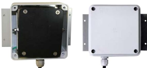
Diese Seite (Bild oben) muss in Richtung des Skifahrers zeigen! Der Distanz von der Fahrtrichtung zum Befestigungspunkt des Radars (siehe Bild rechts) sollte möglichst gering sein (geringer Messwinkel).
