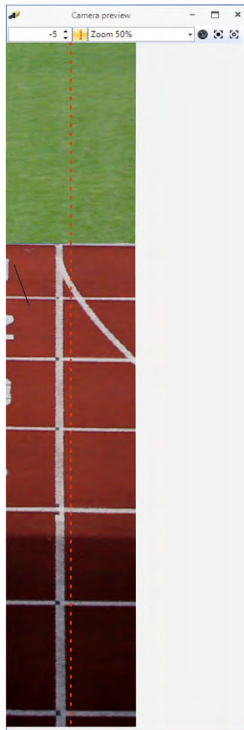
Bild nachdem die Kamera waagrecht ausgerichtet wurde. Verwenden Sie den Getriebeneiger oder die Zeilenverschiebung, um die Aufnahmelinie an der gewünschten Stelle der Ziellinie zu platzieren.
