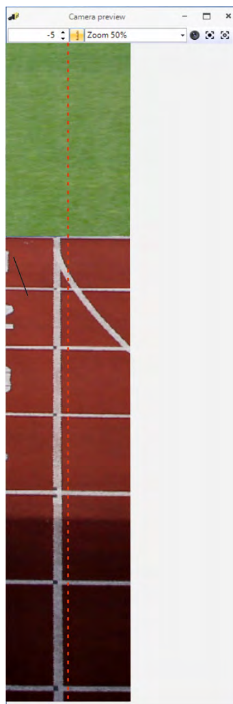
L'image après le réglage horizontal de la caméra. Utilisez la rotule ou le décalage de ligne pour placer la ligne de sélection à l'emplacement souhaité de la ligne d'arrivée.
