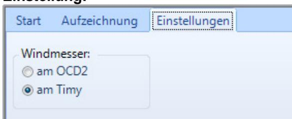
Für Leichtathletik kann man einen Windmesser an das Fotofinish System OPTIc2 anschließen. Wenn Sie eine Distribution Box OCD2 benutzen, können Sie den ALGE Windmesser WS2 direkt an die Distribution Box oder durch einen Timy direkt am PC anschließen.
