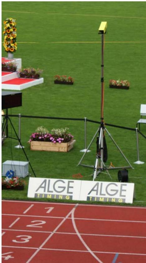
Wird das **Stativ F-STATIV6** mit einer Höhe von 3,66 m für die Kamera verwendet, sollte man für ein Stadion mit 8 Bahnen ein Weitwinkelobjektiv verwenden. Somit kann die Kamera nahe an der nächsten Bahn sein und hat somit einen genügend steilen Winkel, bei dem sich die Läufer nicht zu viel verdecken.
