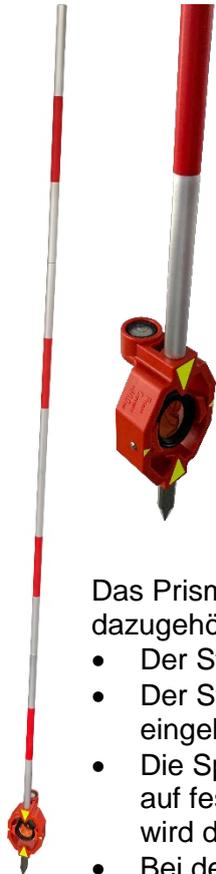
Das Prisma wird für die Messung benötigt. Mit dem Weitenmessgerät wird das Prisma bei der Messung genau angepeilt. Bei der Messung muss der untere Teil vom Prisma auf Bodenhöhe aufliegen, d.h. wenn man im Rasen eine Messung durchführt wird die Spitze in den Rasen bis zum Anschlag in den Rasen gesteckt.
