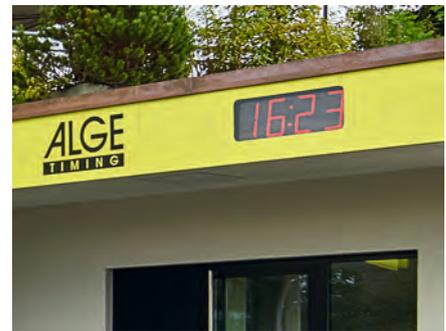
Die Uhren können über RS485 oder Ethernet miteinander kommunizieren. Eine digitale Uhr ist die Hauptuhr und steuert alle Nebenuhren. Die Hauptuhr wird über GPS, DCF, Internet oder einen PC synchronisiert.
