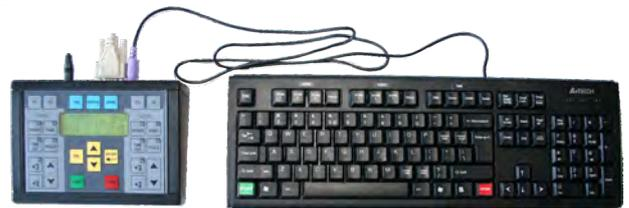
Bedienerterminal D-CKN mit PC-Tastatur
