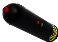
Der WTN-PB ist ein Handtaster mit integriertem WTN Modul. Das Team und der Zeitmesskanal sind einstellbar.
