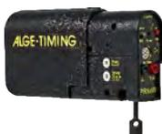
Die PR1aW hat ein eingebautes WTN Funkmodul. Es kann der Impuls per Funk übertragen werden und sie ist mit der kompletten WTN-Serie kompatibel. Bei Bedarf ist auch ein Anschluss der PR1aW per Kabel ans Zeitmessgerät möglich.
