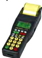
Das eingebaute Funkmodem WTN ermöglicht, den Timy3 per Funk mit allen Geräten der WTN-Serie zu vernetzen. So kann man zum Beispiel Startimpulse, Zwischenzeitimpulse und Zielimpulse empfangen, eine Anzeigetafel steuern und Daten an einen PC mit Auswerteprogramm schicken.
